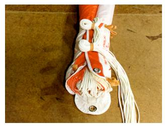
F. BRING THE RUBBER BAND FROM THE BOTTOM STOW THROUGH THE BOTTOM GROMMET ON THE SIDE FLAP.
